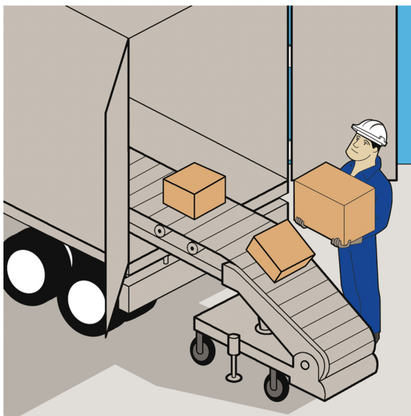
Figura 4.60 Correa transportadora para la descarga de materiales desde un camión.
