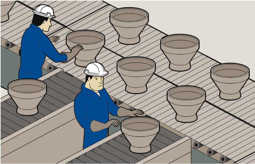
Figura 4.53 Ejemplo de una línea transportadora pasiva para mover piezas pesadas a la altura de trabajo.
