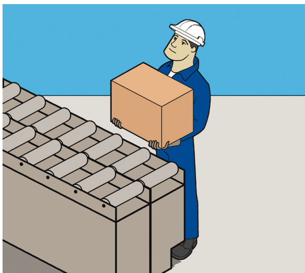
Figura 4.61 La altura de los sistemas de transporte debe permitir el manejo de los objetos sin inclinar el tronco. Además debe existir espacio suficiente para los pies.
