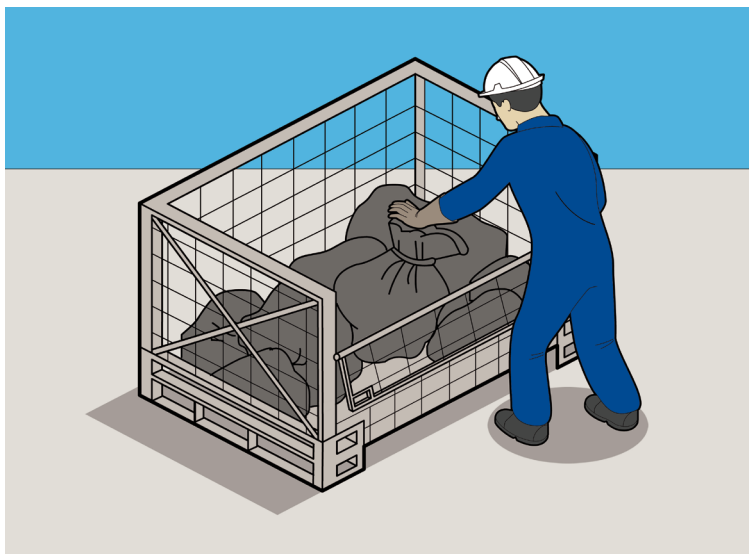
Figura 4.52 Un lado abatible de este contenedor permite acceder más fácilmente a su interior.
