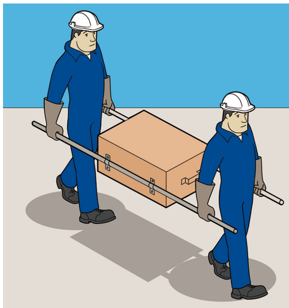
Figura 4.33 Unas barras simples pueden disminuir el esfuerzo de transporte.
