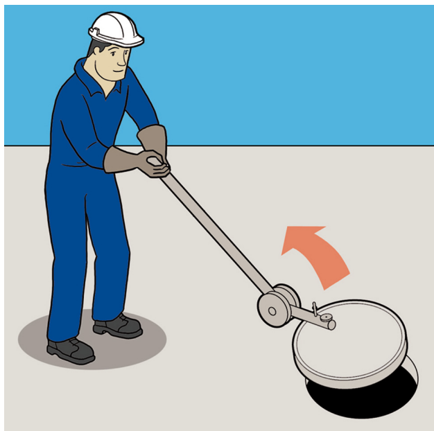
Figura 4.36 El uso de palancas reduce la fuerza necesaria.
