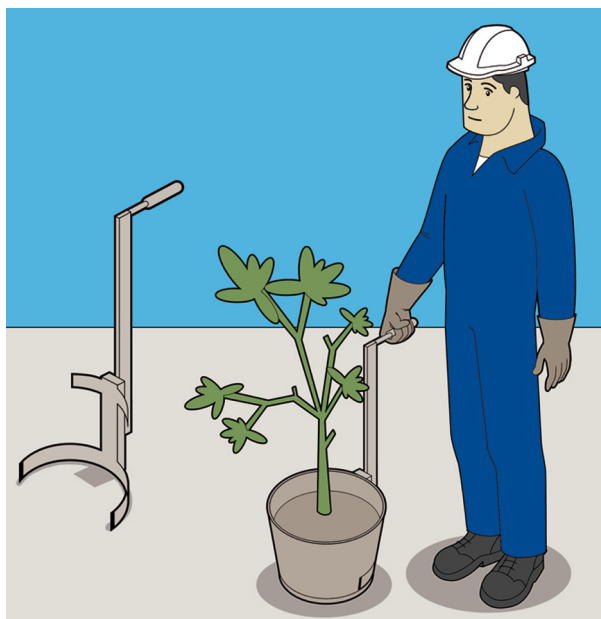
Figura 4.39 Accesorio para transportar objetos cilíndricos (maceteros, latas de pintura, etc.).
